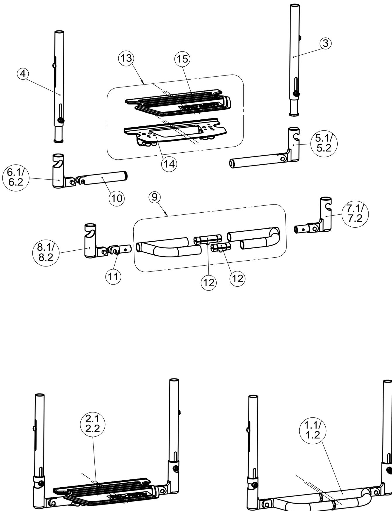
**Fußbügel durchgehend, einseitig hochklappbar, nach außen schwenkbar, höhenverstellbar**
