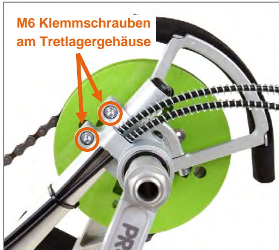
Abbildung 12: M6 Klemmschrauben am Tretlagergehäuse für die Höhenverstellung der Tretlagerposition und den Austausch der Tretlagerstütze
