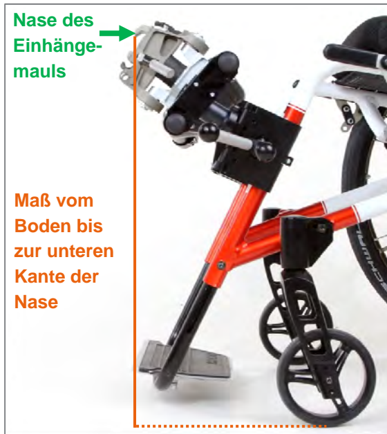
Abbildung 6: Maß vom Boden bis zur unteren Kante der Nase des Einhängemauls
