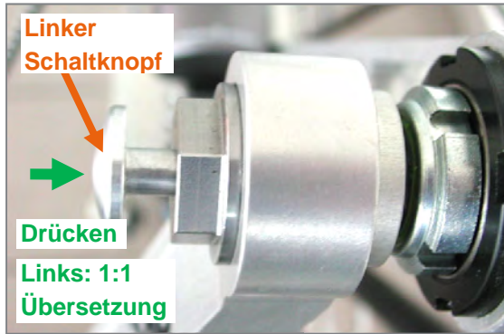
Abbildung 18: Linker Schaltknopf der Tretlagerschaltung
