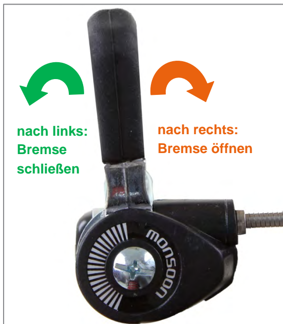
Abbildung 22: Feststellbremse über Bedienhebel bedienbar (geöffnet)
