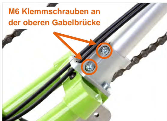
Abbildung 13: M6 Klemmschrauben an der oberen Gabelbrücke für den Austausch der Tretlagerstütze
